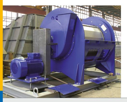
Ein permanent rotierender Schaber säubert das Sieb und das Gehäuse des Trockners. Dadurch wird ein unterbrechungsfreier Dauerbetrieb mit großer Verfügbarkeit möglich.
